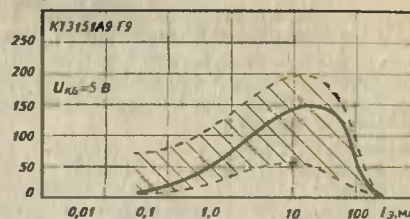
Зависимость статического коэффициента передачи тока от тока эмиттера
