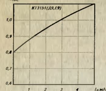
Зависимость напряжения насыщения база-эмиттер от тока коллектора
