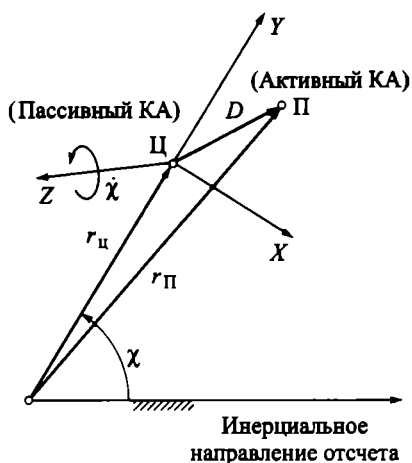
Рис. 5.4. Орбитальная система координат, связанная с объектом встречи (неманеврирующей станцией, находящейся на круговой орбите)
