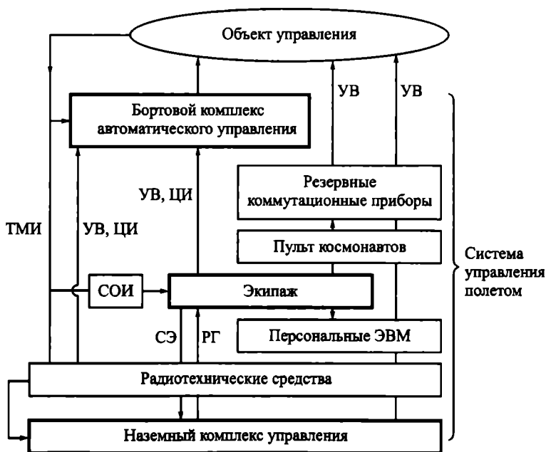
Рис. 1.4. Структура совмещенного контура управления полетом: УВ – управляющие воздействия; РГ – радиогаммы экипажу; СЭ – сообщения экипажа; СОИ – средства отображения информации; ТМИ – телеметрическая информация; ЦИ – цифровая информация
