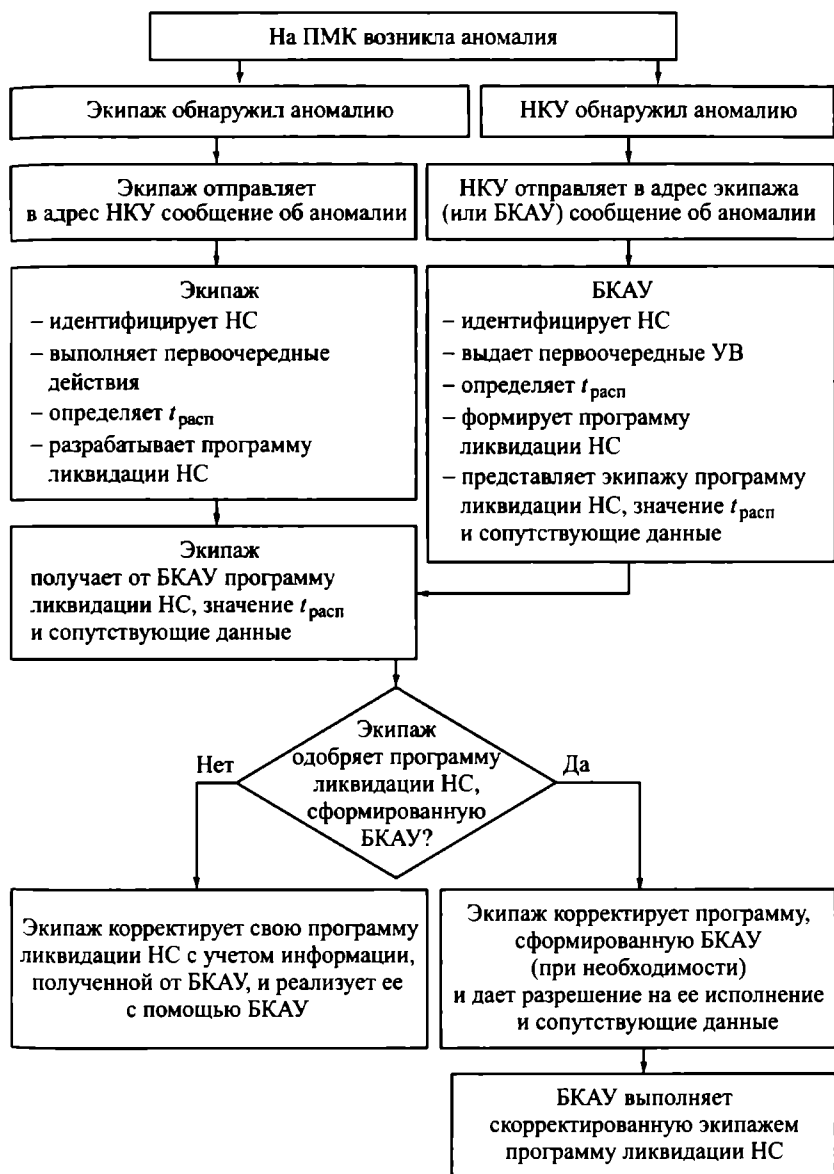
Рис. 21.7. Алгоритм взаимодействия основных звеньев системы управления межпланетным полетом в конфигурации 1 (экипаж и БКАУ) при возникновении НС
