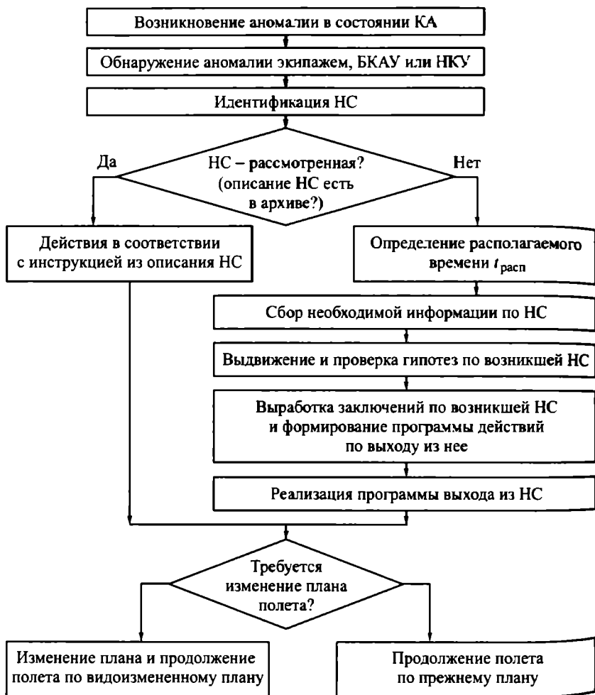
Рис. 16.2. Алгоритм функционирования АСУ КП при возникновении НС
