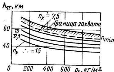
Рис. 10.2.14. Зависимость высоты условного перигея h_\pi от нагрузки \rho_x на лоб и перегрузки n_{max} при \rho_x=400 кг/м 2 , K=0
