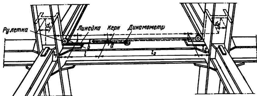
Рис. 137. Посредственное определение крена колонн
