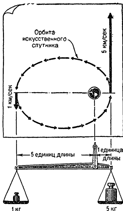
Рис. 7. Аналогия между законом движения спутника по своей орбите и правилом рычага.
