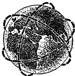
Рис. 1. Искусственный спутник может двигаться только в плоскости, проходящей через центр Земли. Поэтому, в частности, он не может двигаться над какой-либо параллелью за исключением экватора.
