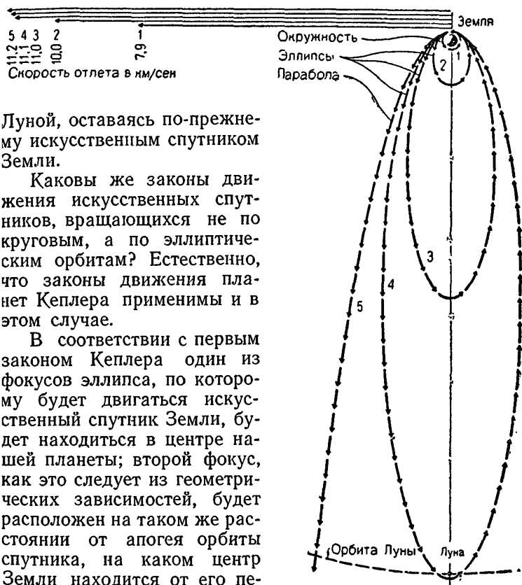
Рис. 5. Зависимость формы орбиты ракеты от начальной скорости.
