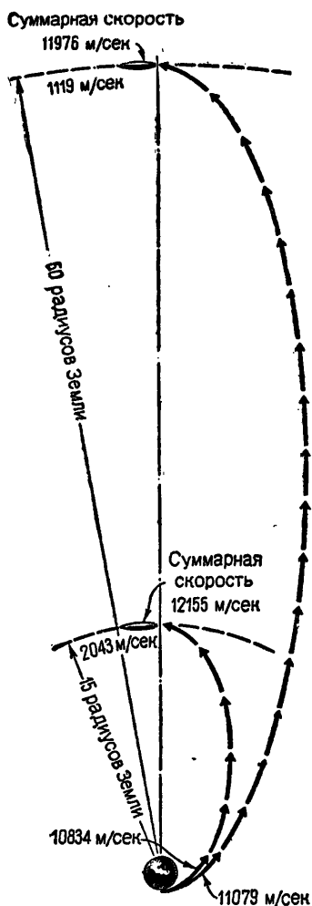
Рис. 30. Запуск искусственного спутника по полуэллиптической траектории. Орбитальной ракете двукратно сообщается горизонтально направленная скорость: при взлете с поверхности Земли и в апогее. Иногда, как это показано на рисунке, может получиться, что при запуске по такому методу на большую высоту потребуются израсходовать меньше топлива.
