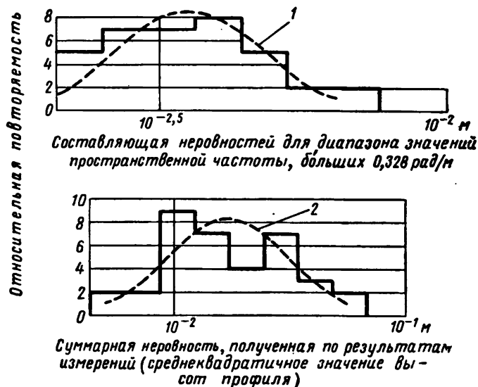
Рис. 3.2. Распределение повторяемостей неровностей для 36 профилей взлетно-посадочных полос стран, входящих в НАТО:
