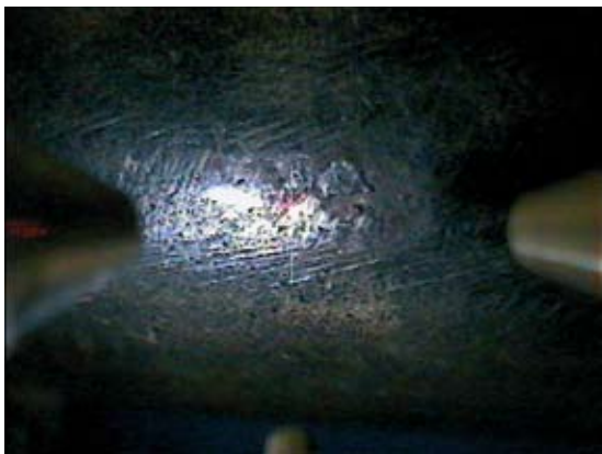
Рис. 5. Проба металла, полученная на втулке изделия: Cu – 65,97; Sn – 31,63; Pb – 2,08; Bi – 0,02; Fe – 0,29
