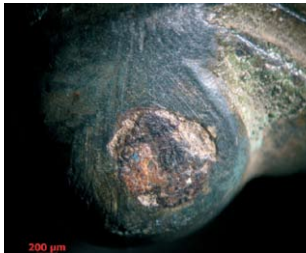
Рис. 4. Затеки бронзы на железном штыре в глазнице
