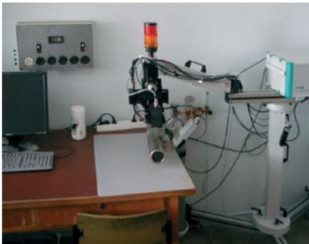
Рис. 2. Прибор ArtTAX для неразрушающего анализа элементного состава металлов и сплавов
