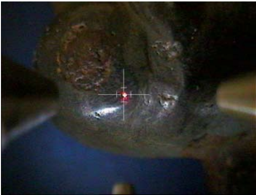
Рис. 6. Проба металла, полученная в области птичьего глаза: Cu – 48,97; Sn – 37,06; Pb – 4,12; Bi – 0,02; Fe – 0,29
