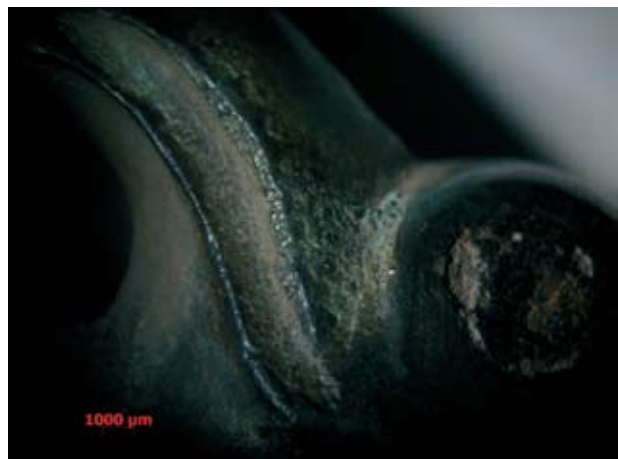
Рис. 10. Плотная бугристая коррозия в области птичьего глаза и клюва
