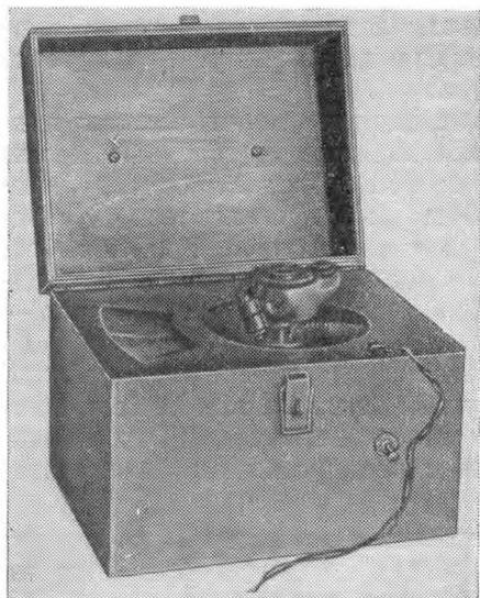
Фиг. 124. Прибор для измерения момента трения в подшипнике 832901Б.
