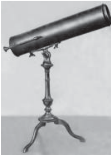
Рефлекторный телескоп или рефлектор, оптический прибор, в котором роль объектива выполняет вогнутое зеркало с наружным отражательным слоем
