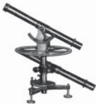
Теодолит — инструмент для измерения как горизонтальных, так и вертикальных углов при производстве геодезических, инженерных и астрономических работ Западной Европа. XVIII в. Государственный Эрмитаж, Санкт-Петербург
