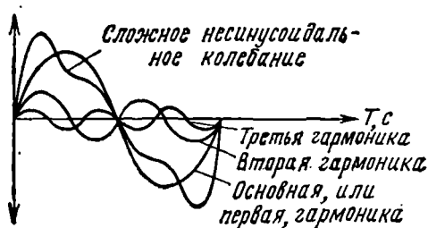
Рис. 4. График сложного несинусоидального колебания
