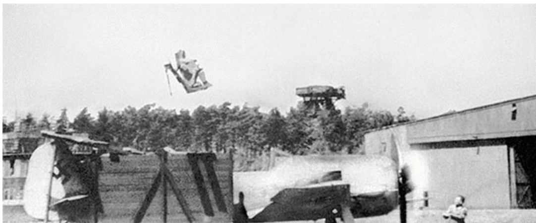
Испытание катапультируемого кресла Fw-190
