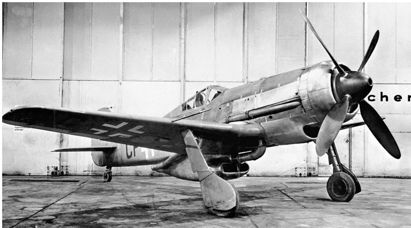
Опытный истребитель с турбокомпрессором Fw-190V-18/U1
