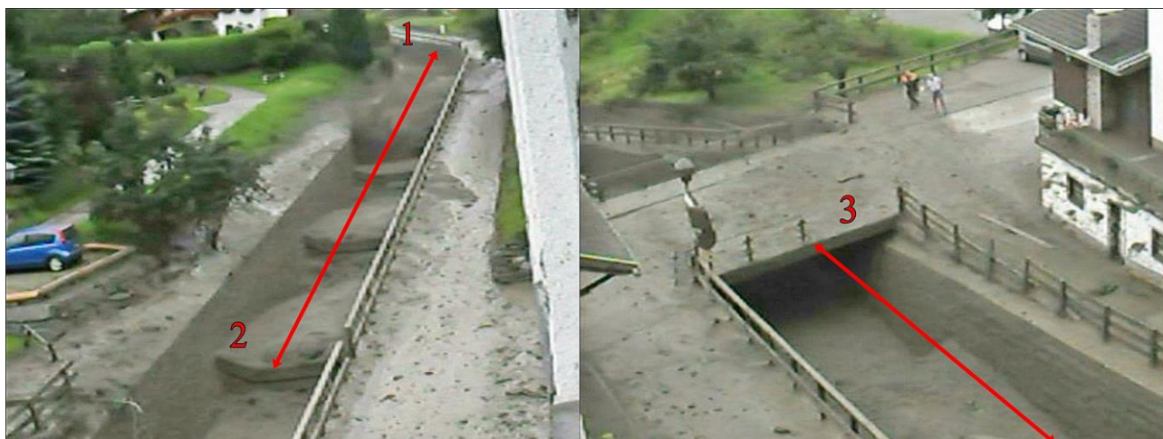
Рисунок 3. Схема участков прохождения селевого потока: 1 – ступень на повороте, 2 – ступень напротив парковки, 3 – мост.
