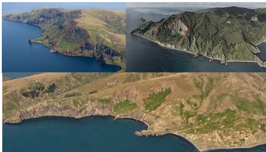
Рисунок 11. Оползневые цирки блоковых оползней в скальных породах
