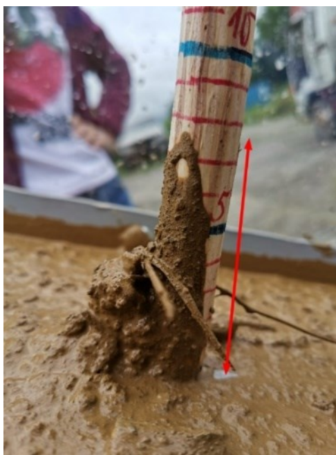
Рисунок 1. Селевые обмазки на вешке показывают величину гидродинамического напора селя Figure 1. Mudflow coatings on the rod show the value of the hydrodynamic pressure of the mudflow
