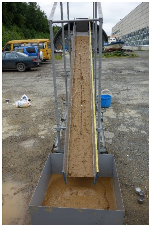
Рисунок 2. Селевые отложения Figure 2. Mudflow deposits
