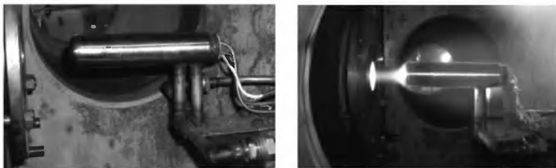
Рис. 10.5. Датчик для измерения высоких тепловых потоков до и во время эксперимента
