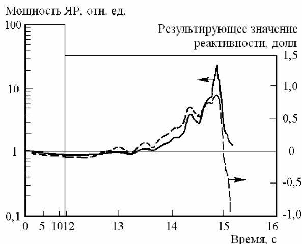
Рис. 5.17. Изменение мощности ЯР и реактивности в неконтролируемом аварийном режиме, связанном с остановкой циркуляции теплоносителя.
