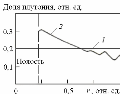
Рис. 2.14. Перераспределение плутония в топливе с исходной композицией (U_{0,8}Pu_{0,2})O_2 : 1 - до облучения; 2 - после облучения.
