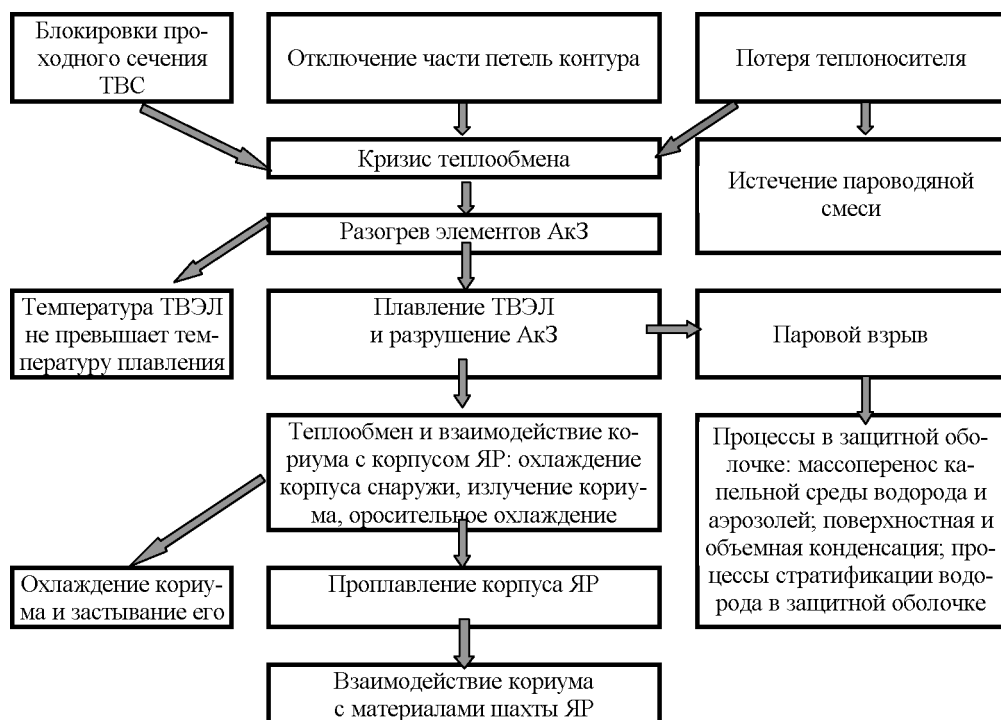
Рис. 1.12. Общая схема возникновения и развития тяжелой аварии ядерного энергоблока с ЯР водо-водяного типа.
