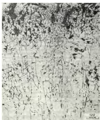
Рис. 2.5. Структура пузырьков газовых продуктов деления в облученном топливе (выгорание – 0,8 %, линейная мощность – 50 кВт/м).
