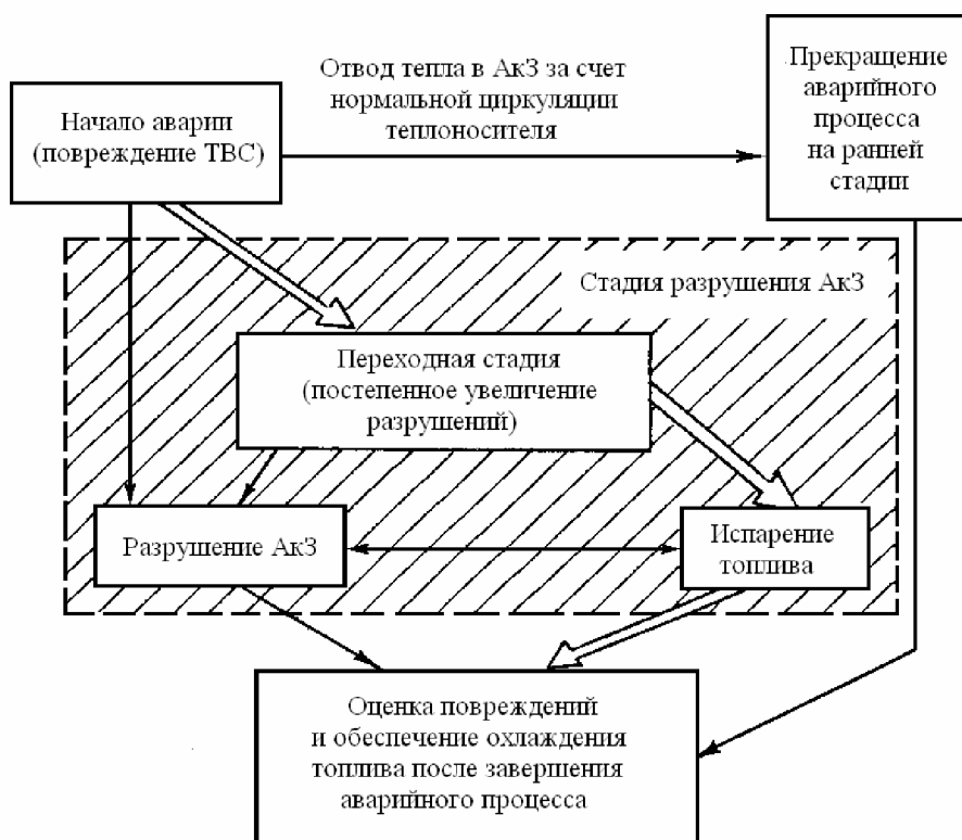
Рис. 5.19. Вероятные пути развития неконтролируемого аварийного процесса, связанного с ухудшением теплоотвода в ЯР.
