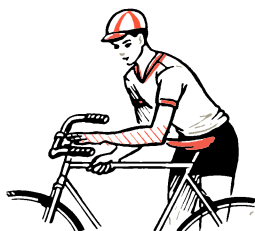
Рис. 5. Установка седла по длине
