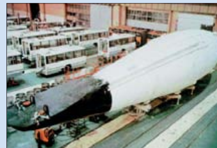
Макет топливного бака системы МАКС в цеху НПО «Южное»: вид спереди (слева) и сзади (справа)
