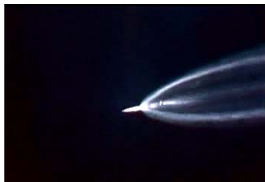
Фото 3-б. Зазор между ступенями увеличивается. Скачок уплотнения начинает терять яркость.
