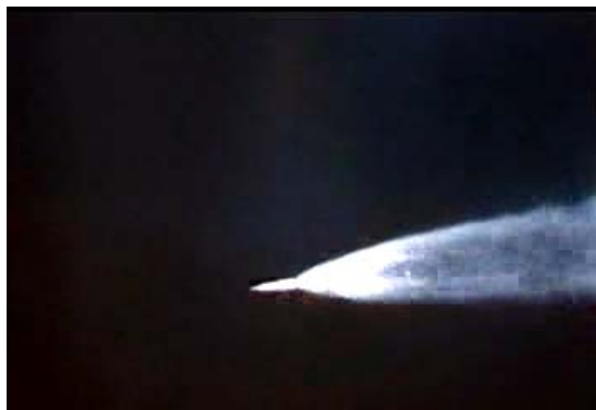
Фото 2-а. Кадр непосредственно перед началом видимого роста облака «взрыва», связанного с работой РДТТ (188 кадр)
