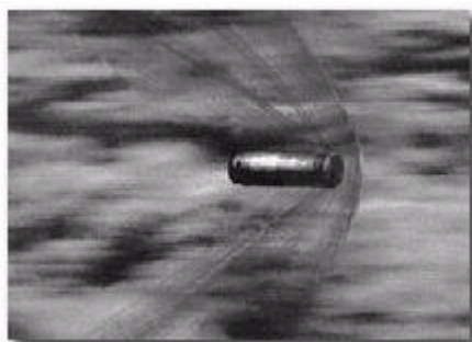
Фото 5. Летящий со сверхзвуковой скоростью снаряд. Расходящиеся в стороны «усы» – скачки уплотнения воздуха, приобретающие на некотором расстоянии от тела конусообразную форму. Перед тупой головной частью виден прямой скачок уплотнения.
