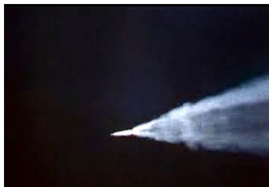
Фото 1-б. Полет ракеты через 4 кадра после выключения маршевых ЖРД первой ступени. Включены РДТТ осадки топлива, расположенные на второй ступени.
