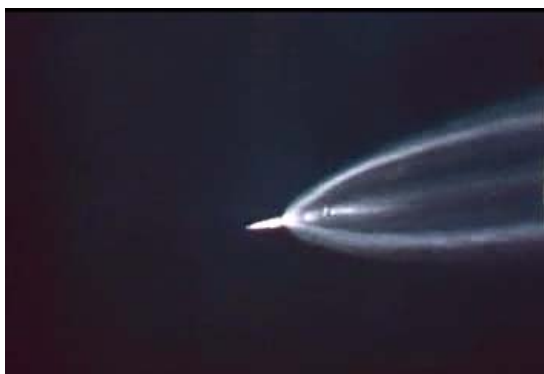
Фото 3-а. Фиксируется яркое свечение в зазоре между ступенями, свидетельствующее о работе двигателей 2-ой ступени. (266 кадр)
