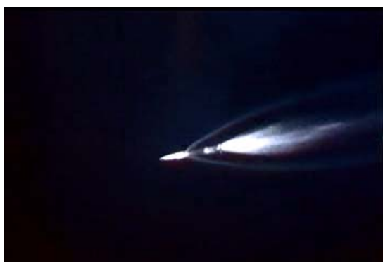
Фото 3-в. Зазор увеличивается еще больше. В промежутке между ступенями просматривается струя двигателей второй ступени.
