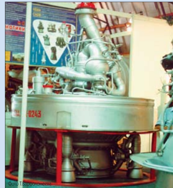
Двигательная установка первой ступени БРПЛ РСМ-54
