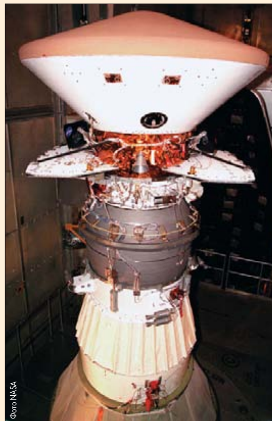
Mars Polar Lander состыкован с третьей ступенью
