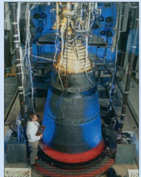
Двигатель RL-10B-2 с развернутым сопловым насадком
