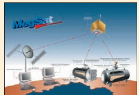
Возможные схемы работы КА системы MegSat с потенциальными наземными потребителями в однопользовательском и многопользовательском режимах
