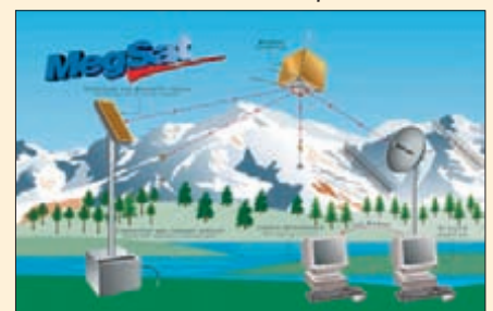
Возможные схемы работы КА системы MegSat с потенциальными наземными потребителями в однопользовательском и многопользовательском режимах
