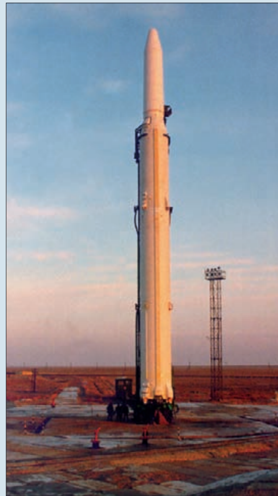
Спутники «Плазма-А» также, как и аппараты УС-А, запускались на орбиту с помощью РН «Циклон-2»
