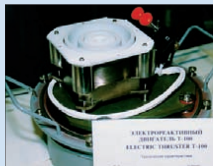
Стационарный плазменный двигатель Т-100, разработанный в Исследовательском центре им. М.В.Келдыша
