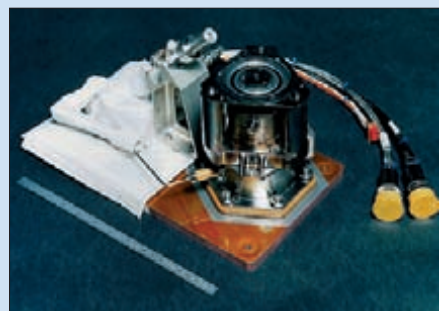
Стационарный плазменный двигатель TAL-WSF, а по сути Д-55, успешно работает на американском военно-исследовательском КА STEX
