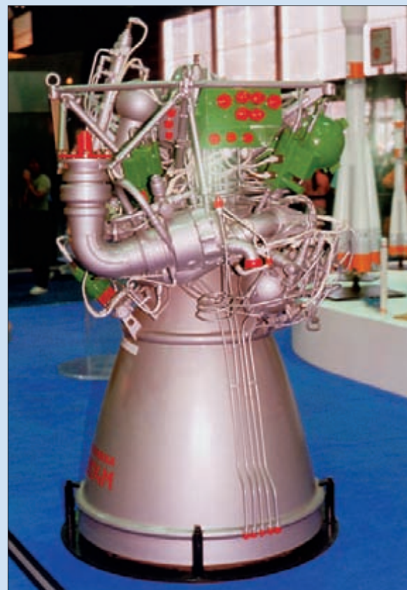
Однокамерный двигатель РД-0124М для «Руси»
