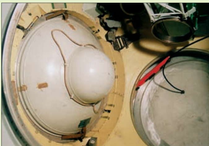
Шлюзовая камера: слева – закрытый люк стыковочного механизма; справа внизу – вход в пусковую камеру; вверху – манипулятор КСИ
