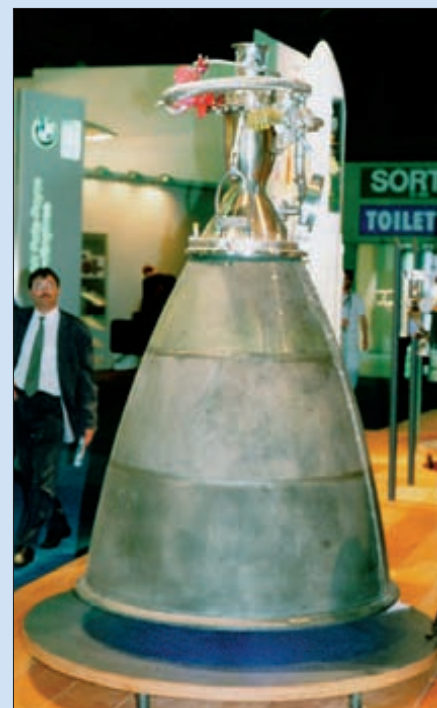
ЖРД Aestus, работающий на топливе «азотный тетроксид–монометилгидразин».
