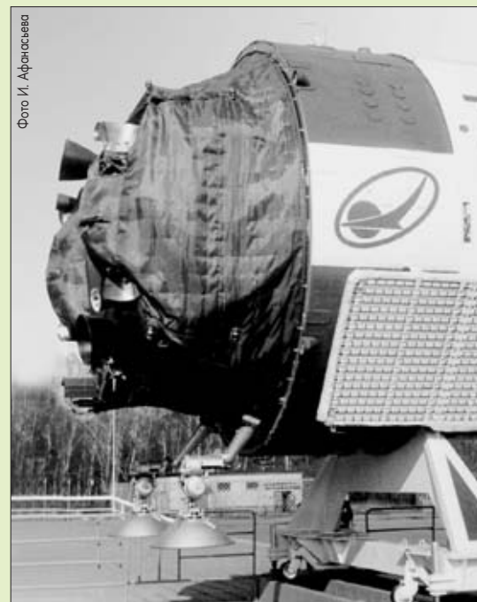
Хвостовая часть автоматического «Алмаза» внешне мало отличалась от аналогичного узла пилотируемой станции: видны сопла двигателей и стыковочный отсек, закрытый теплоизоляцией
