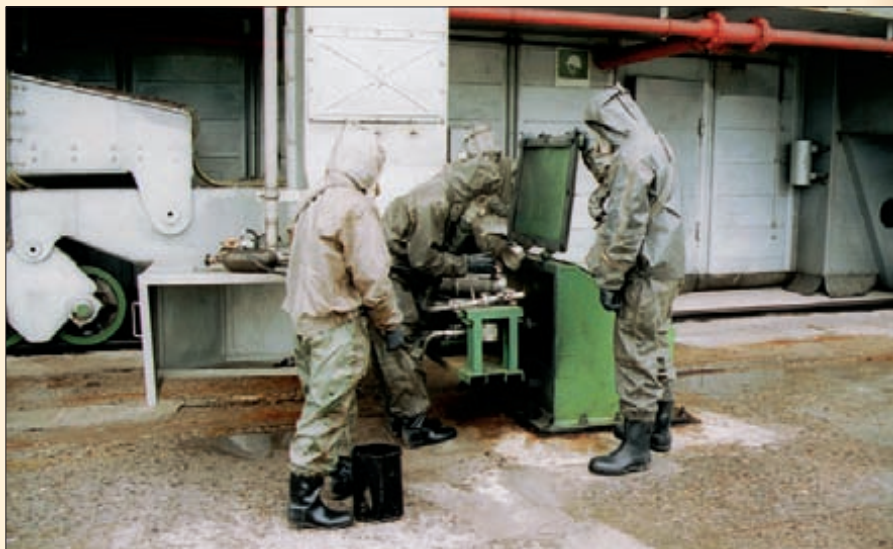
Стыковка запровочных коммуникаций на 1-й ступени РН «Космос-3М»
