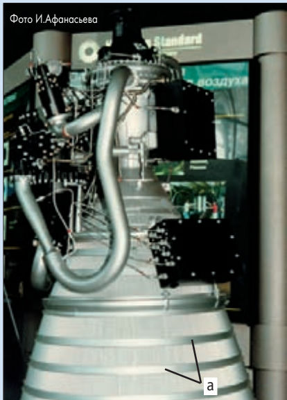
Камера сгорания и турбонасос RL-10. Не эти ли кольца (а) виноваты?
