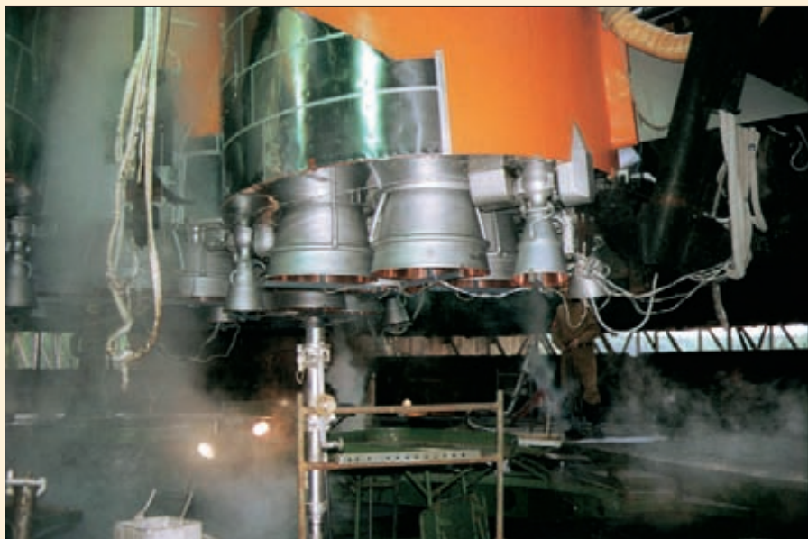
Этап подготовки ракеты – опускание площадок колонн обслуживания
