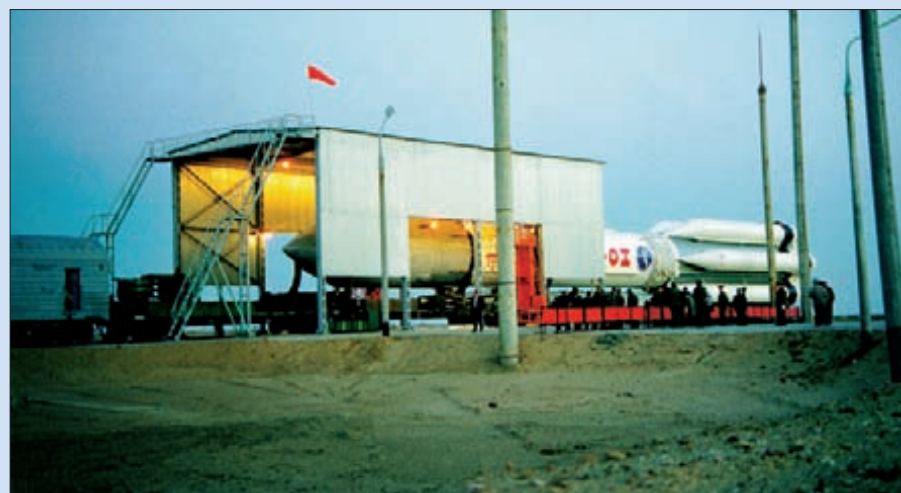
А так проходила заправка разгонного блока «Бриз-М» носителя «Протон-К», предшествующая неудачному запуску КА «Радуга» 5 июля 1999 года. Красный флаг на крыше таковым не является, это указатель ветра.
