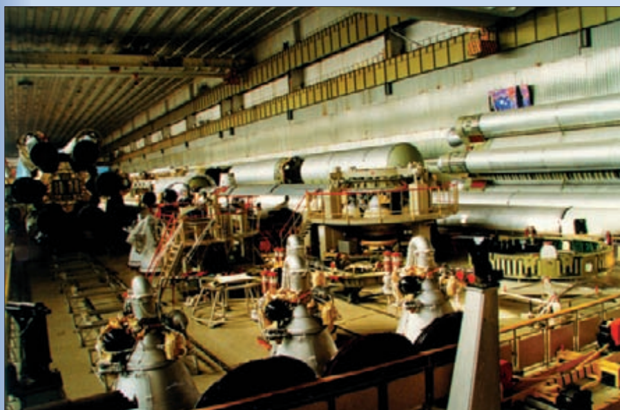
Участок подготовки двигателей 1-й, 2-й и 3-й ступеней перед их установкой на РН в Центре Хруничева
