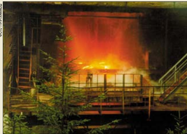
Огневые испытания двигателя РД-120К для носителя «Единство»
