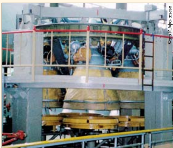
Двигательная установка 2-й ступени РН «Протон-К» на сборке
