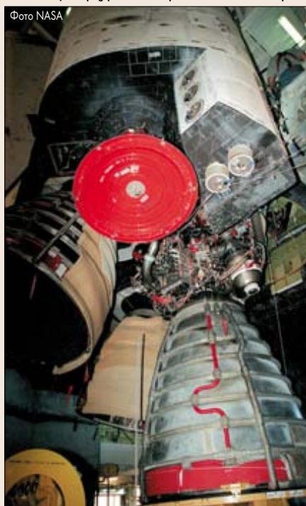
А пока на «Дискавери» меняют маршевый двигатель №3
