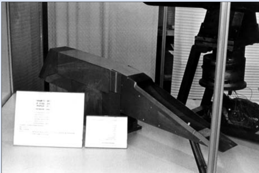
Модуль экспериментального ГПВРД разработки ТМКБ «Союз»
