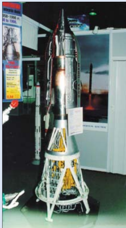
Экспериментальный ГПВРД разработки ЦИАМ и КБХА, использованный в исследованиях по программе «Холод»
