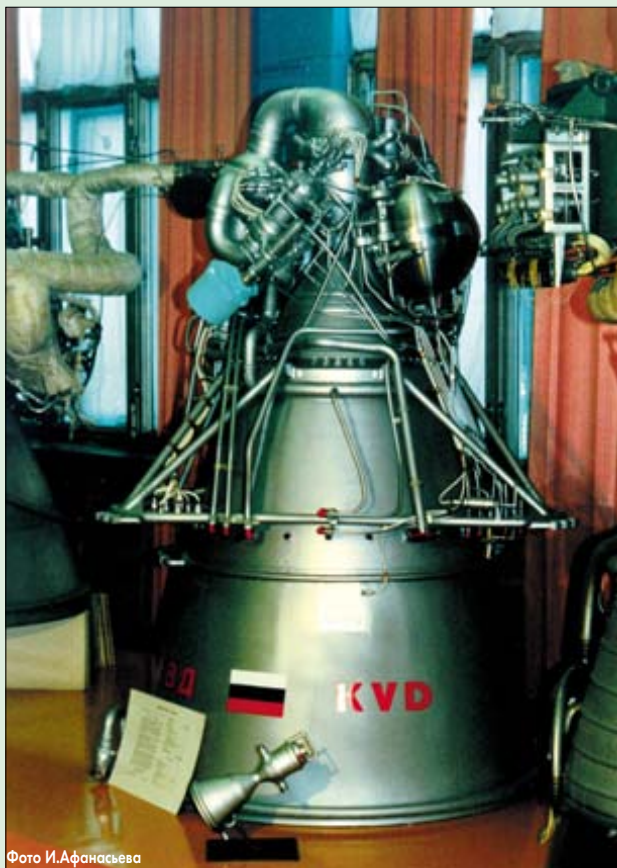
Кислородно-водородный двигатель КВД-1 для установки на разгонный блок 12 КРБ
