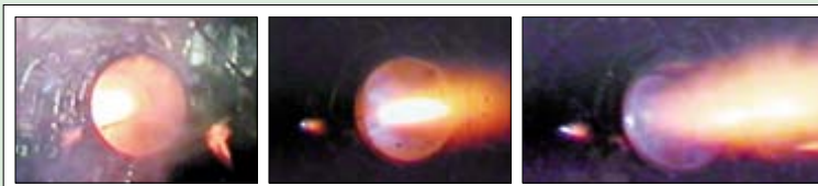
Кинограмма запуска двигателя КВД-1 на стенде
