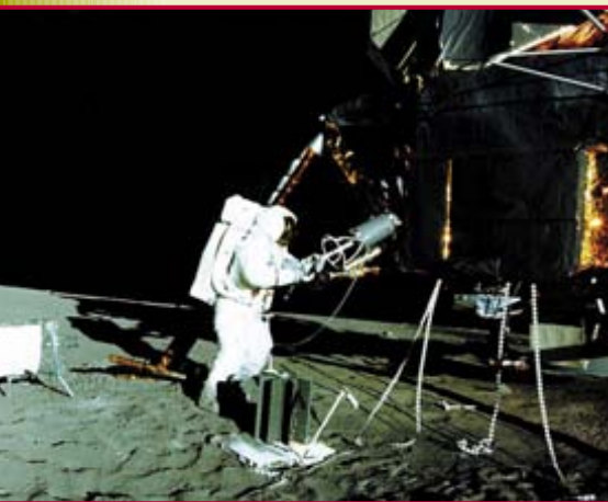
Алан Бин извлекает из гильзы плутониевый топливный элемент
