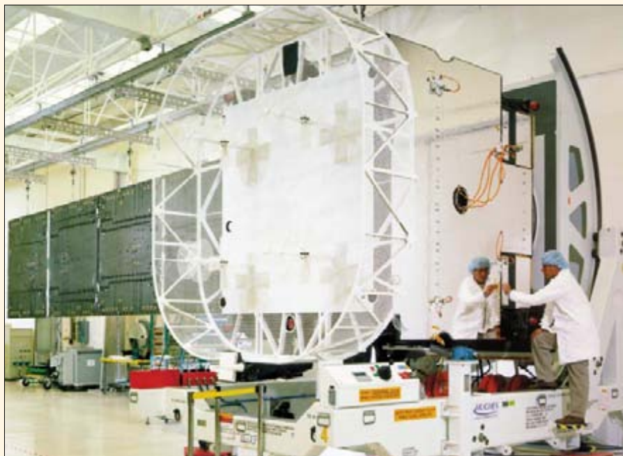
Работники компании Hughes проводят последние проверки перед отправкой КА UHF F/O F10 на космодром
