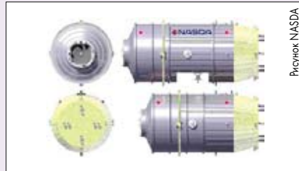
Два типа корабля HTV – с герметичным ГО и смешанного типа
