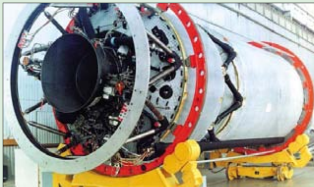
Блок 12КРБ разработки КБ «Салют» для ракеты-носителя GSLV
