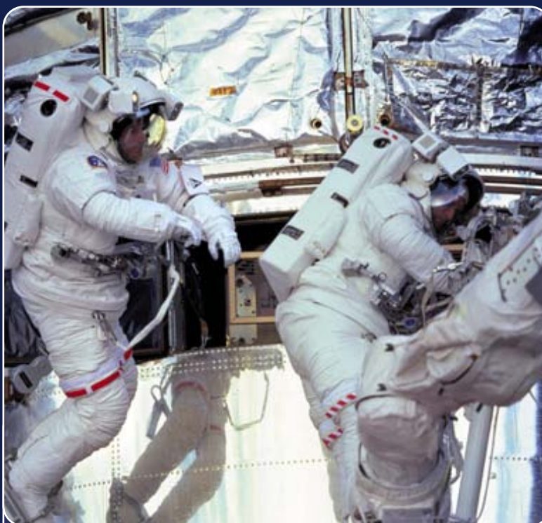
Фуул и Николье занимаются заменой датчика точного гидирования FGS-2
