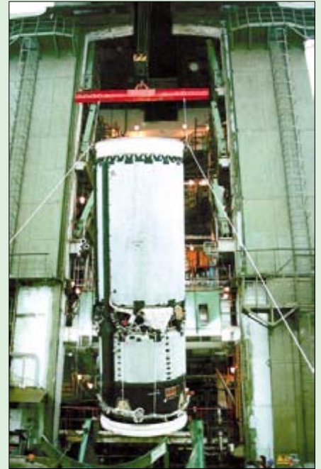
20 декабря 1998 г. блок 2Д112КРБ был установлен на стенд В3Е КВКС-106 для проведения холодных и огневых испытаний
