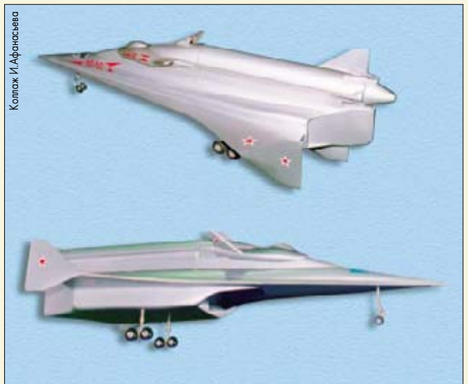
Модель двухступенчатой воздушно-космической системы «Спираль»
