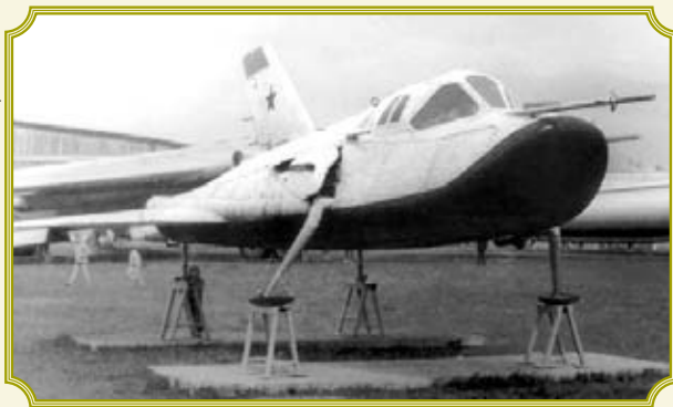
Аналог «105.11» в музее ВВС (Монино). Обратите внимание на конструкцию посадочных опор (фото вверху) и крышку ниши шасси (фото справа)
