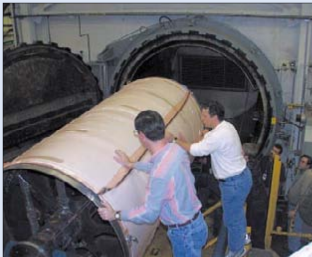
Установка обечайки бака X-34 в автоклаве
