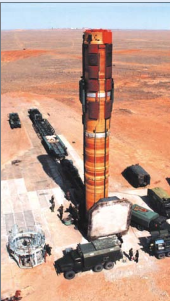
Контейнер с ракетой перед установкой в шахтную пусковую установку
