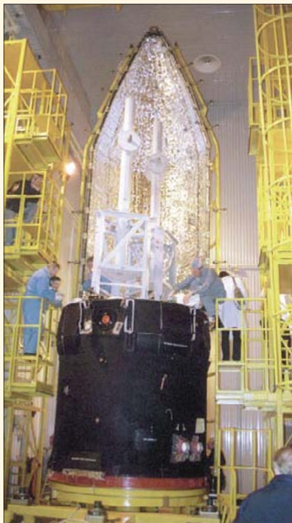
Установка эквивалента полезной нагрузки на РБ
