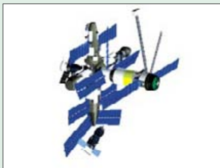
Кадр цифрового видеоролика Н.К.Петрова: момент за 3 сек до столкновения корабля «Прогресс М-34» со станцией «Мир». Цифровой формат позволяет управленцам ЦУПа точно решать задачи ближней навигации.
