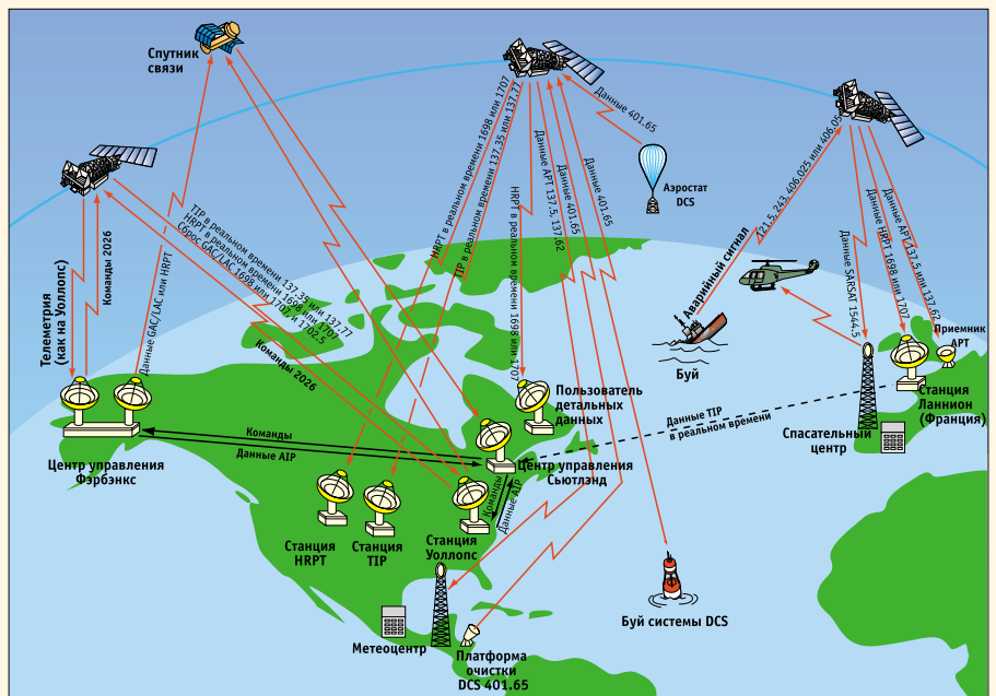
Схема использования частот (МГц) спутниками типа NOAA-K
