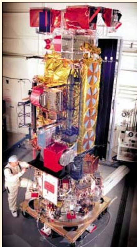
1 – платформа аппаратуры; 2 – инерциальный измерительный блок; 3 – разворачиваемый экран; 4 – AVHRR; 5 – жалюзи СТР (15 шт); 6 – приемная антенна системы SRSAT; 7 – всенаправленная антенна диапазона S (6 шт); 8 – аккумуляторы; 9 – двигатели ориентации; 10 – привод СБ; 11 – SBUV/2; 12 – AMSU A2; 13 – передающая антенна системы SRSAT; 14 – антенна ОБЧ-диапазона реального времени; 15 – антенна «Маяка»; 16 – AMSU B; 17 – антенна УВЧ-диапазона системы DCS; 18 – AMSU A1; 19 – антенна передатчика S-диапазона (4 шт); 20 – датчик Земли; 21 – HIRS.
