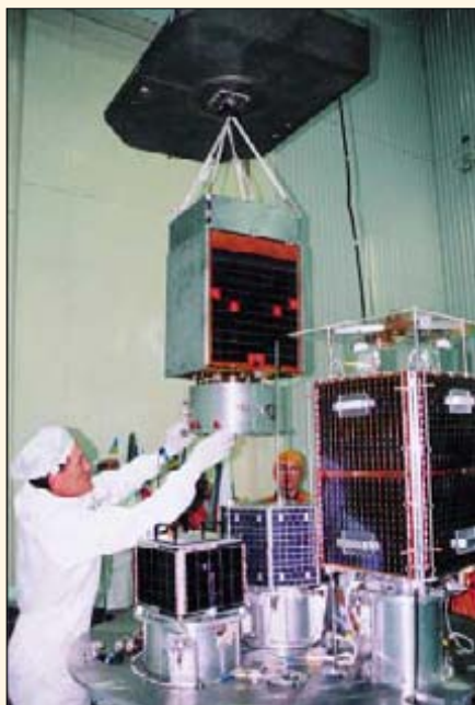
Спутники с адаптерами устанавливаются на опорную плиту
