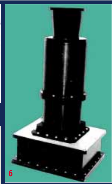
4 – широкополосный оптико-электронный преобразователь на основе матриц ПЗС ВЗН; 5 – цифровой электронный блок; 6 – оптико-электронная камера КОЭ-03
