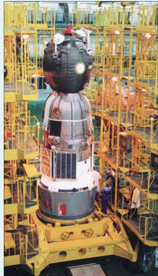
▲ Редкий кадр. Корабль на Земле без ступеней. Обратите внимание на расцветку экранно-вакуумной теплоизоляции
