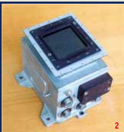
1 – датчик измерения координат центра Земли; 2 – прибор БОКС с рабочим полем 92°x48° и точностью 1'; 3 – оптико-электронная звездная камера с обнаружительной способностью до 12 м
