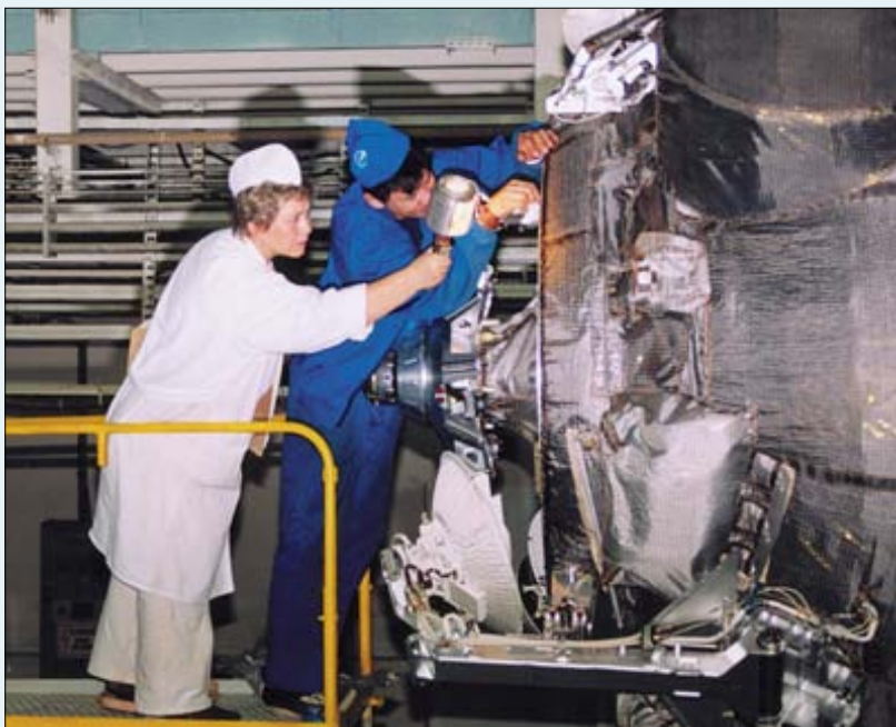
▲ Заключительный осмотр механизмов стыковочного узла
