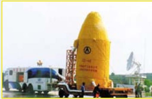
Перевозка загерметизированного головного обтекателя CZ-4B с КА
