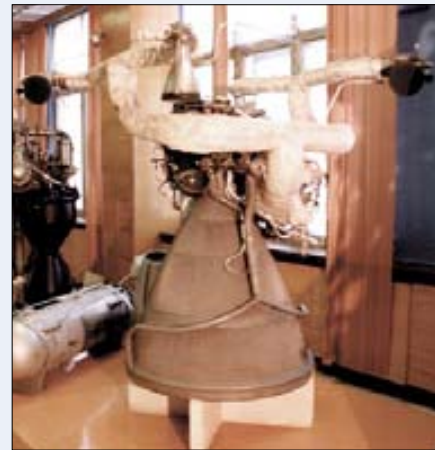
Двигатель 11Д49, установленный на второй ступени РН «Космос-3М»
