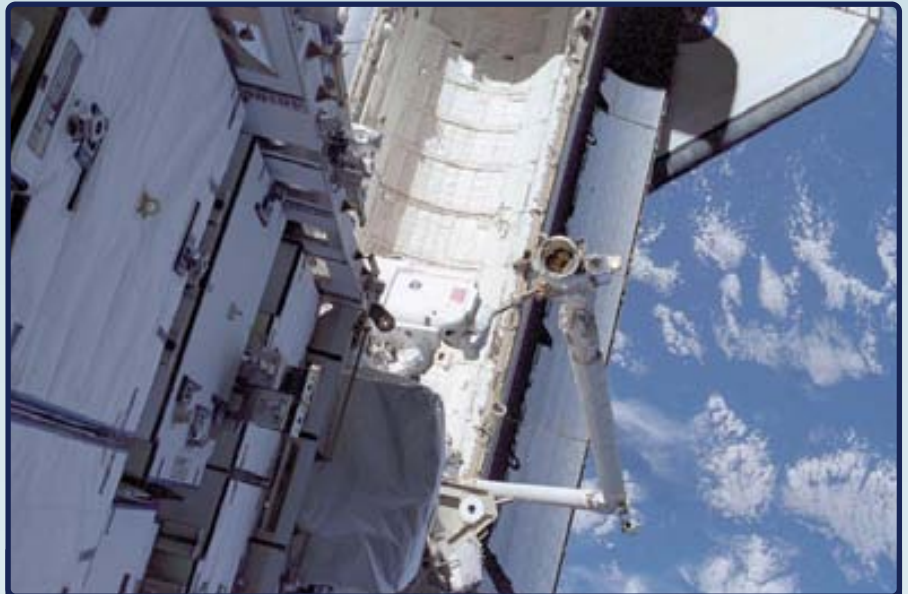
Первый выход – монтаж фермы к платформе Z1
