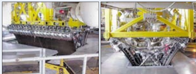
«Двухдвигательная» конфигурация «аэроспайка», подготовленная к стендовым испытаниям
