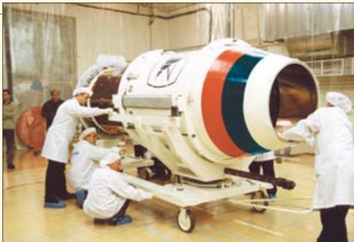
Формирование головной части – накатка опекателя на спутник в «чистом» помещении монтажно-испытательного корпуса космических аппаратов
