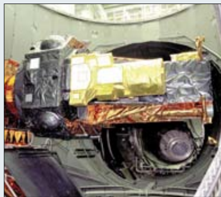
Макет КА «Интеграл» в ходе испытаний. Цилиндрический желтый элемент – спектрометр, за ним – гамма-телескоп
