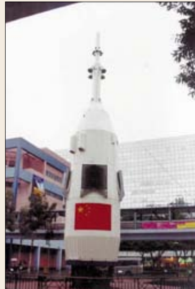
Головной обтекатель КК «Шэнь Чжоу» с двигательной установкой системы аварийного спасения
