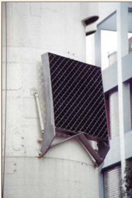
Решетчатые аэродинамические стабилизаторы на обтекателе ракеты CZ-2F
