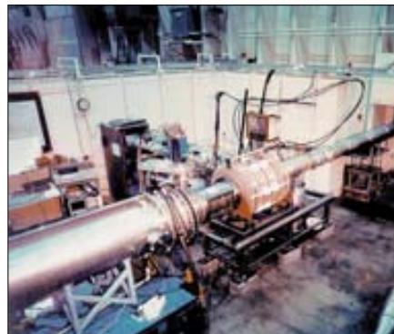
CBW-волновод установки HERTF
