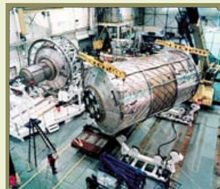
Модуль Destiny в Центре Маршалла (на заднем плане – американская шлюзовая камера МКС)
