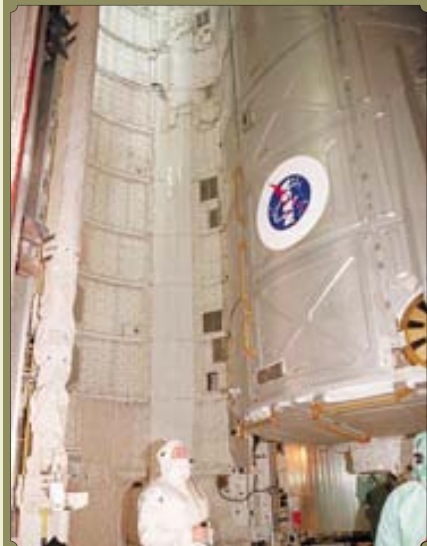
Установка модуля Destiny в грузовом отсеке «Атлантика»
