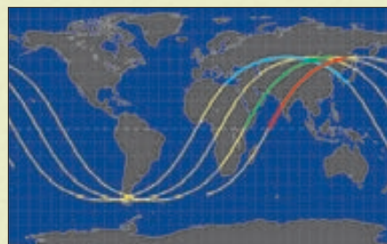
Последние витки полета ОК «Мир». Цветом выделены участки работы двигателей на торможение
