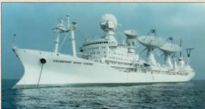
«Космонавт Юрий Гагарин» – флагман кораблей, обеспечивающих управление пилотируемыми и другими научными КА, оснащенных радиотехническим комплексом с антеннами, имеющими зеркало диаметром 25 м
