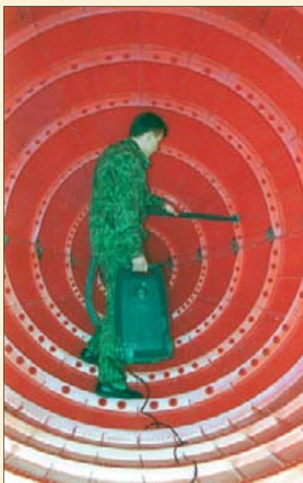
Чистка обтекателя производится с помощью обыкновенного бытового пылесоса
