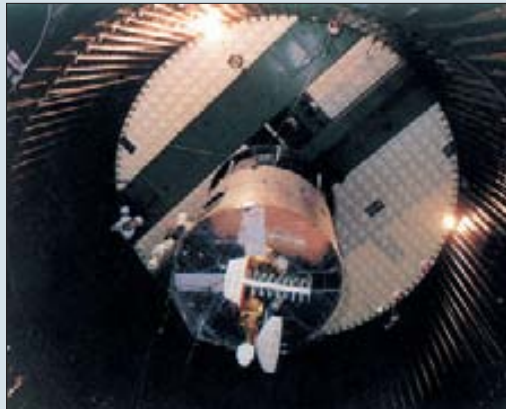
Геостационарный метеоспутник FY-2 во время испытаний
