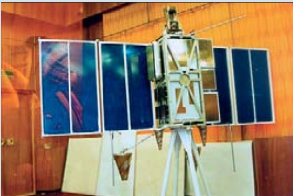
Макет платформы МКА Д33, на базе которой планируется создавать КА проекта ЕМЕС. Фото КБ «Полет»
