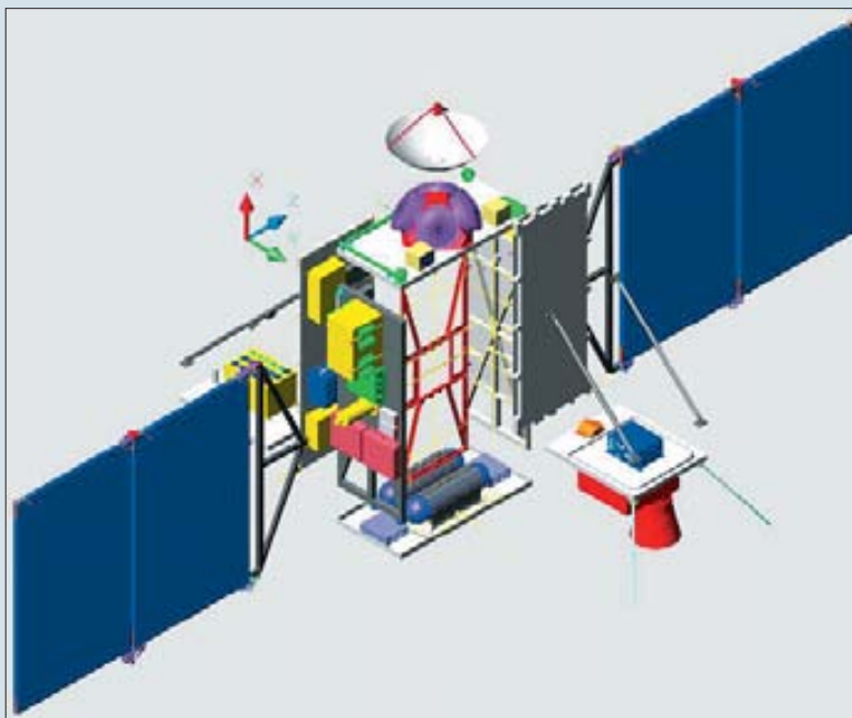
Конструктивно-технологическое членение МКА Д33, на базе которого будут создаваться КА проекта ЕМЕС. Рисунок КБ «Полет»
