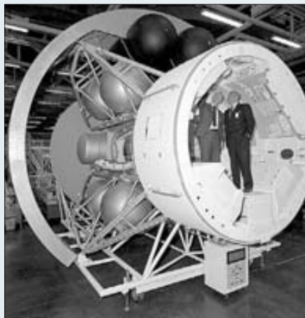
Шлюзовая камера американской станции Skylab
