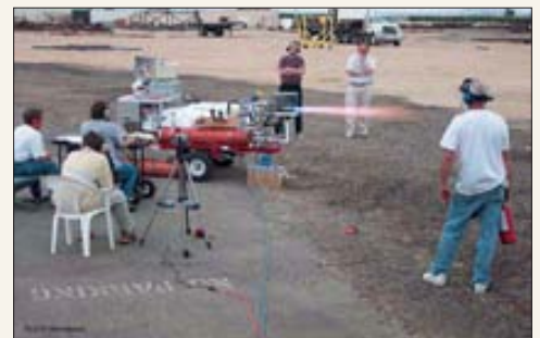
Испытания двигателя на мобильном огневом стенде
