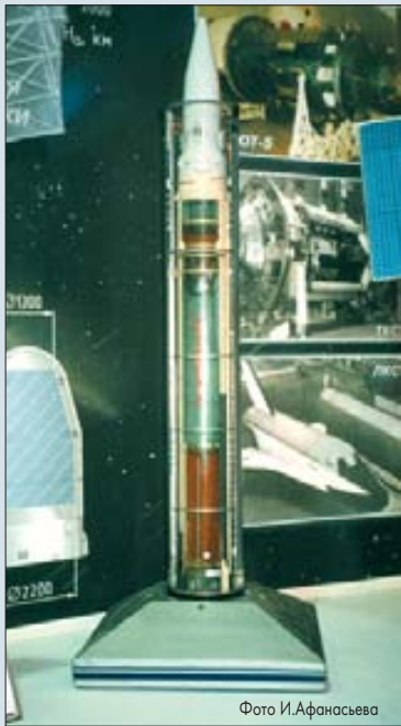
Макет РН «Стрела» с одним из вариантов головного обтекателя Фото И.Афанасьева
