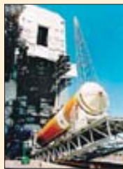
1. Начало подъема ракеты в вертикальное положение на Комплексе 37. 2. Единный центральный блок СВС вывозится на стартовый стол. 3. Ступень установлена в вертикальное положение с помощью стационарного подъемника
