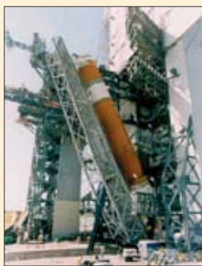
1. Начало подъема ракеты в вертикальное положение на Комплексе 37. 2. Единный центральный блок СВС вывозится на стартовый стол. 3. Ступень установлена в вертикальное положение с помощью стационарного подъемника
