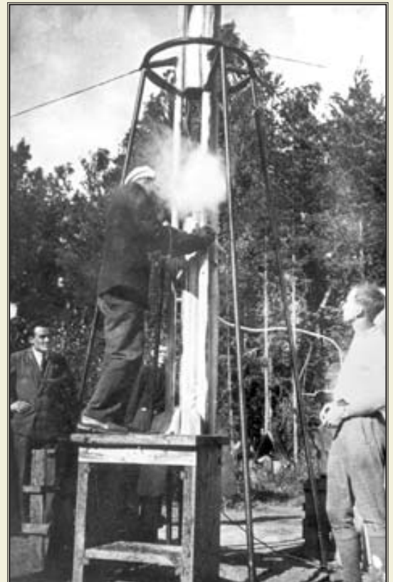
Заправка жидким кислородом первой советской жидкостной ракеты ГИРД Р-1 (объект 09). 13 августа 1933 г.
