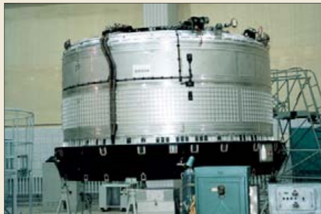
Сбрасываемый торовый бак разгонного блока «Бриз-М»
