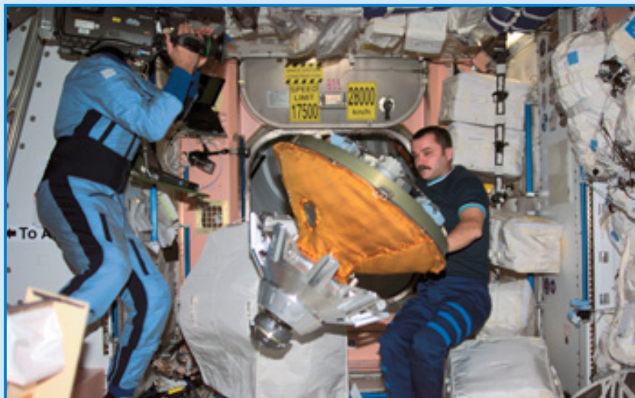
Перенос стыковочного конуса для приема СО «Пирс»
