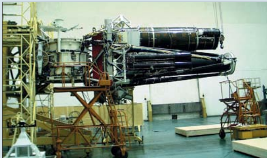
Инженерная модель КА. Общие электрические испытания разобранного комплекса
