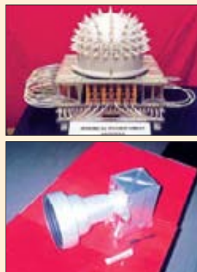
Полусферическая антенна ФАР для передачи информации на малогабаритные приемные станции (вверху); звездный датчик системы ориентации
