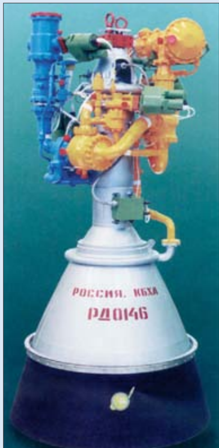
Газогенераторный кислородно-водородный РД-0146
