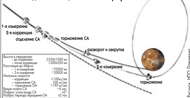
Схема подлета станции М-71 к Марсу
