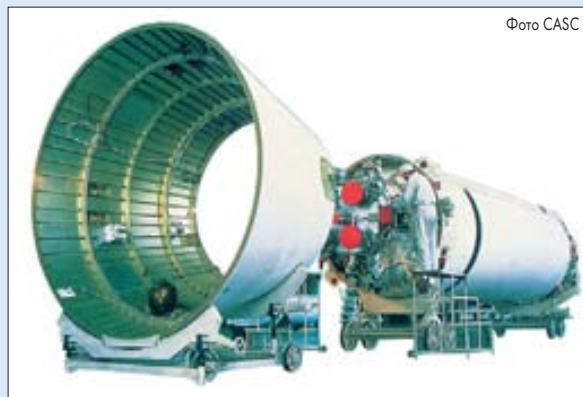
Третья ступень носителя LM-3 с кислородно-водородным двигателем YF-73
