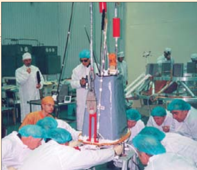
Установка МКА «Компасс» на автономную платформу отделения
