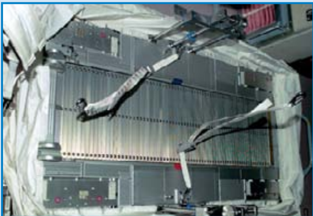
Система виброизоляции бегущей дорожки TVIS
