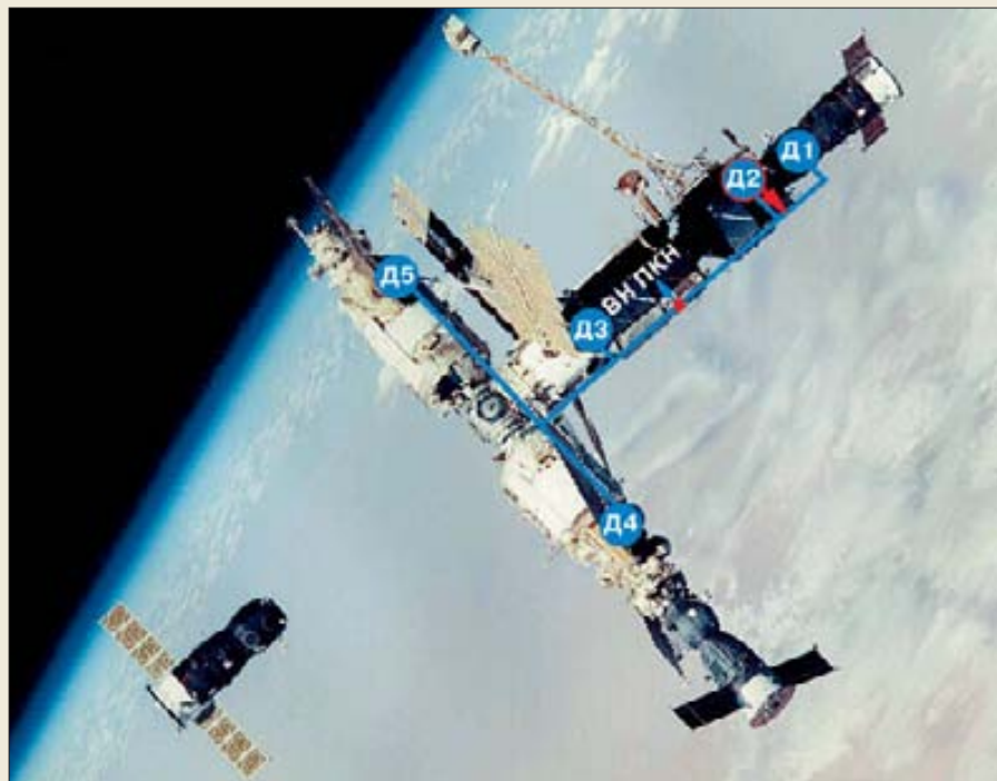
Схема расположения аппаратуры комплекса «Гермес» на борту ОК «Мир»: ВН – вычислитель негерметичности; ПКН – пульт контроля негерметичности; Д1...Д5 – аппаратура контроля негерметичности «Дюза-2М»
