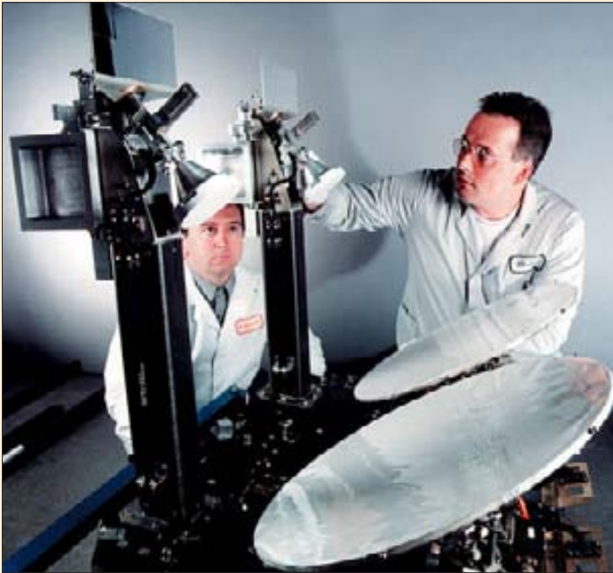
«Антенна для обслуживания рассредоточенных пользователей» (distributed user coverage antennas, DUCA) из комплекта аппаратуры MDR
