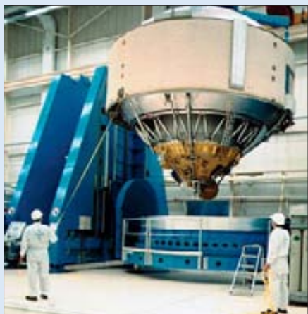
Внешний вид новой криогенной ступени ESC-A
