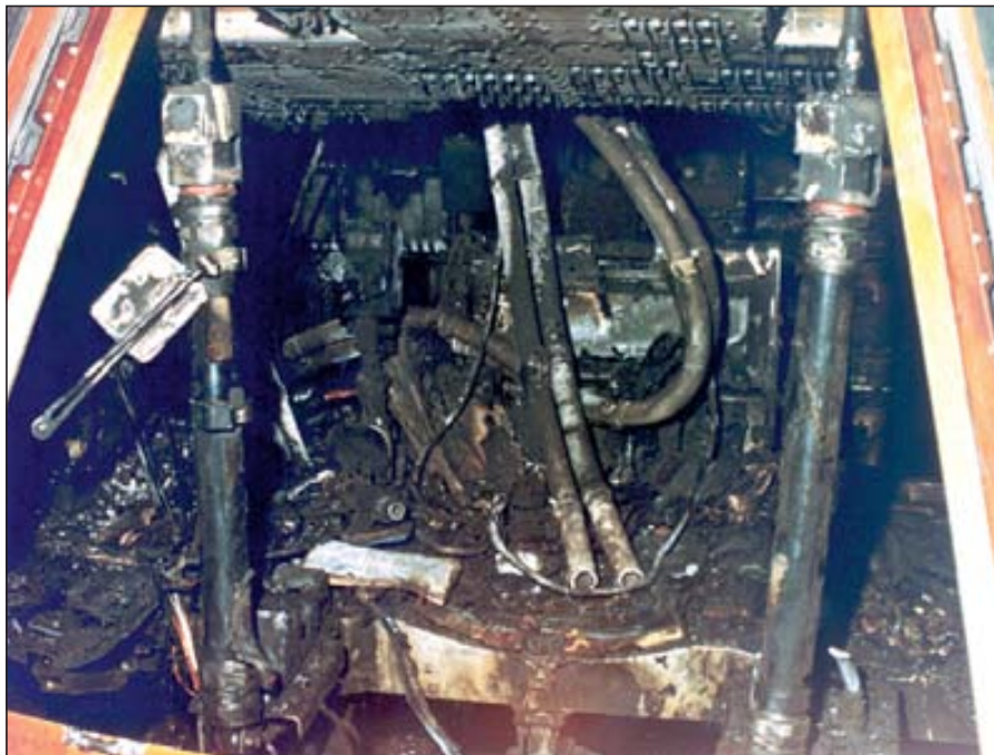
Вид кабины через люк после пожара
